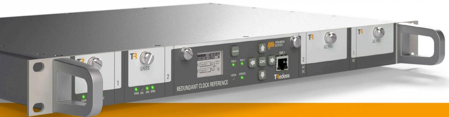
TRedess社冗長対応参照クロックは、マルチバンド & マルチコンステレーションGNSS受信機、外部1PPS 入力ソース、PTP マスタークロックなどの複数の同期入力ソースから内部の高性能OCXOを内部的に制御できるため、重要な同期アプリケーションに正確で安定した時間、及び周波数信号を提供し、幅広いシナリオに対応します。これらの同期ソースとOCXO 間の切り替えは、1PPS、及び10MHz 出力におけるタイミング/振幅/位相ノイズの影響を受けることなく手動、又は自動で実行できるため、完全にシームレスな操作が可能です。
